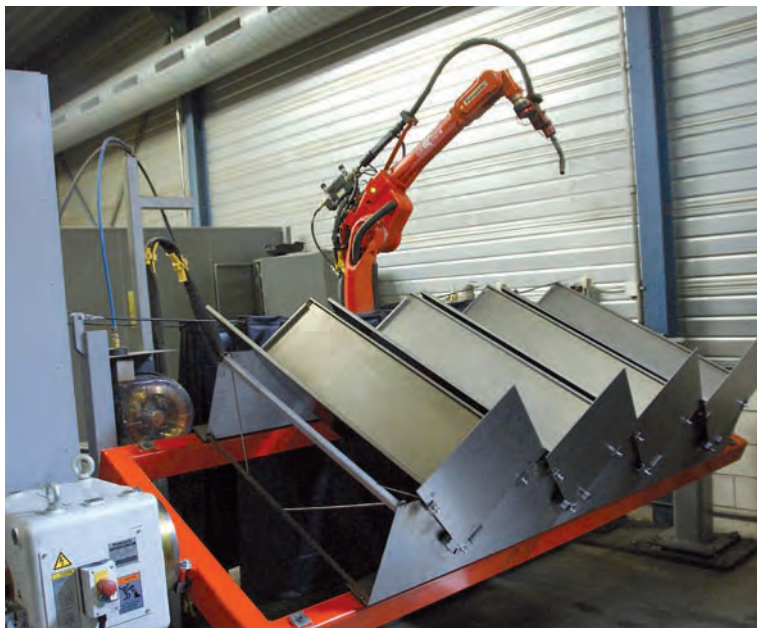
De opspantafel van 3 m kan worden afgestemd op de plaatafmeting.
