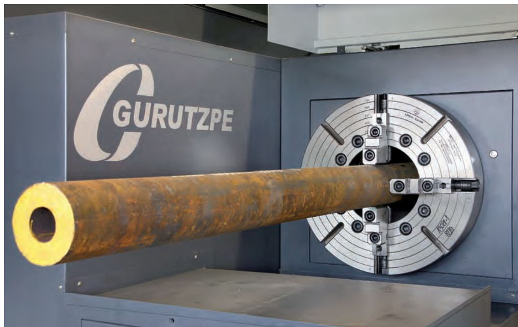
Doorvoer aan de kopse kant met extra klauwplaat op de hoofdspindel voor langere werkstukken.
