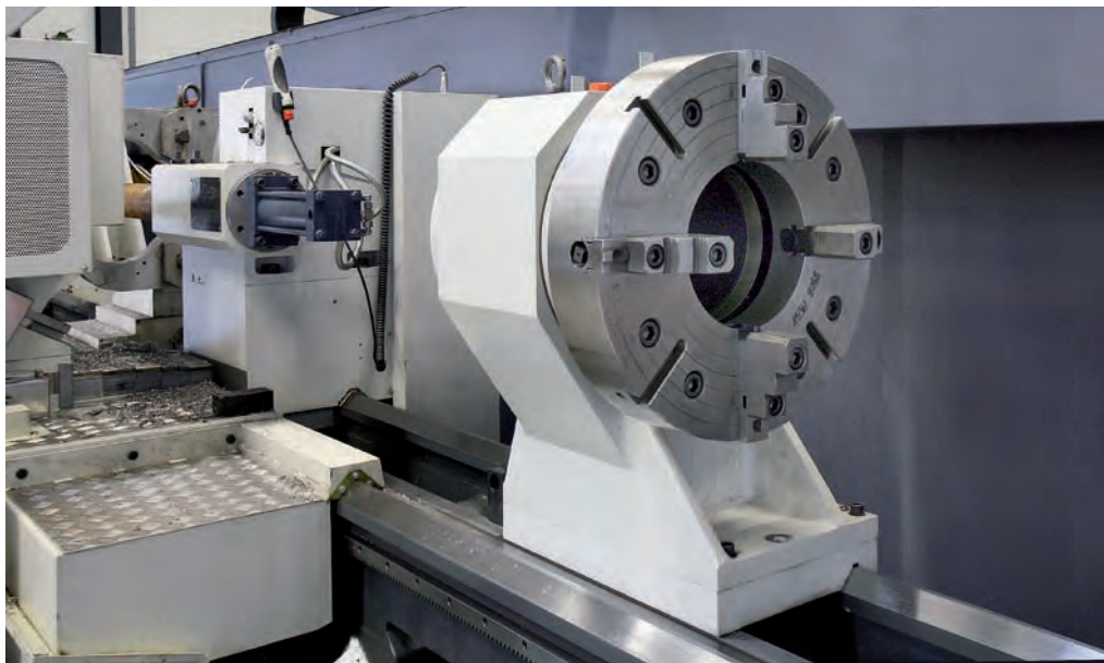
De Jakom-sleeve – een meedraaiende subspindel met klauwplaat – vereenvoudigt opspanning van werkstukken zonder center.
