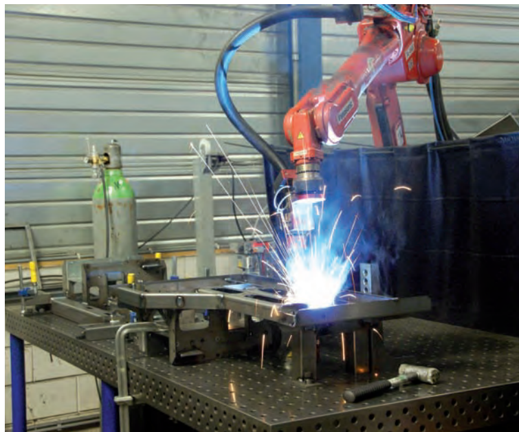
Voor producten die tijdens het lassen niet gemanipuleerd hoeven te worden zet Bromedo een vaste opspantafel in.
