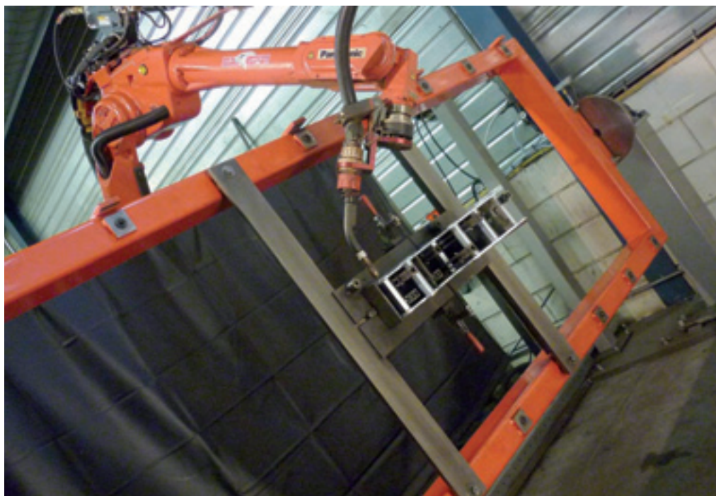
De lasrobotinstallatie met twee werkstations van drie meter was te groot voor kleine producten.
