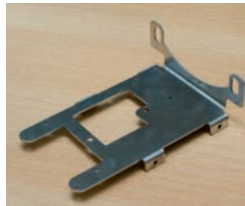
De basis van dit werkstuk is gemaakt op de combilaser (lasersnijden/ponsen), waarna het op de zetbank is afgewerkt.
