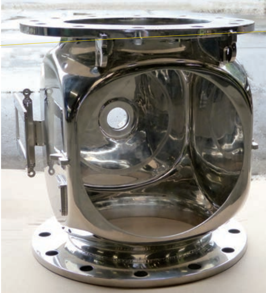
Vloeiende vervorming in het interieur van een magneetfilterhuis.
