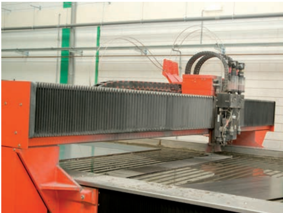
De mogelijkheden van de Bystronic waterstraalsnijmachine (werkbereik 3 x 6 meter) zijn spectaculair.
