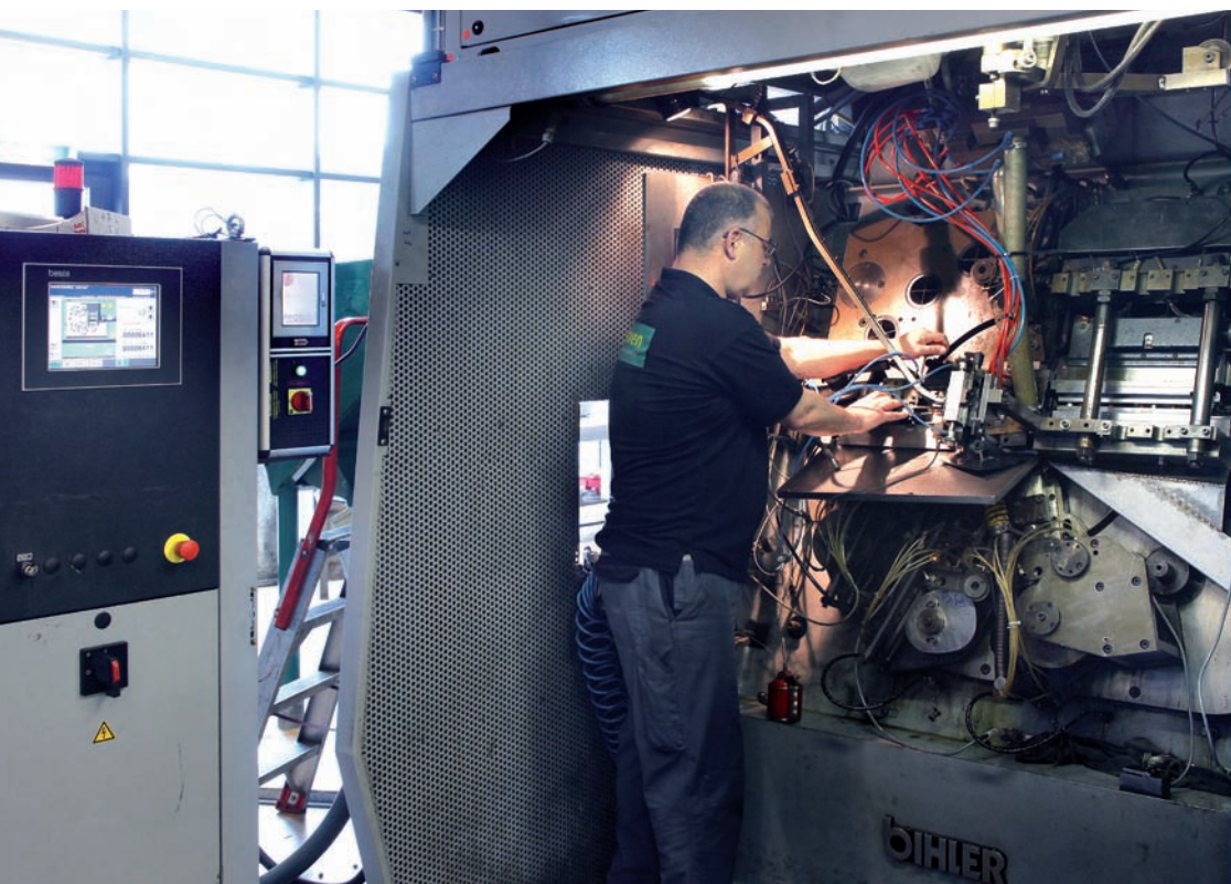
Intuïtie en vakmanschap zijn belangrijke pijlers bij familiebedrijf Walraven. Op de foto maakt een medewerker een stempel voor een bevestigingsbeugel.
