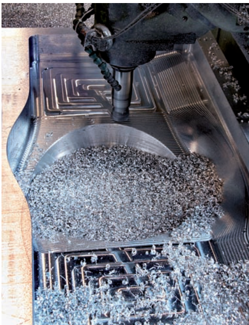
Met het frezen van matrijzen verbreden de modelmakerijen hun dienstverlening.
