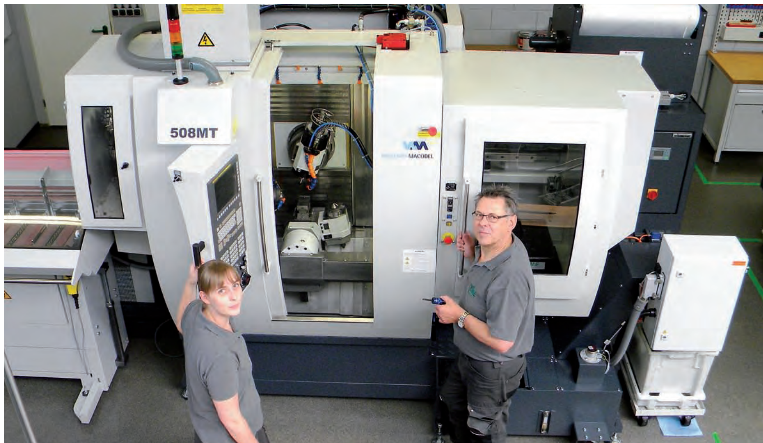
Nikki en Henkjan van der Zouw bij het 508MT bewerkingscentrum van Willemin Macodel, met links het automatische stafaanvoerapparaat en rechts de laad-losrobot.
