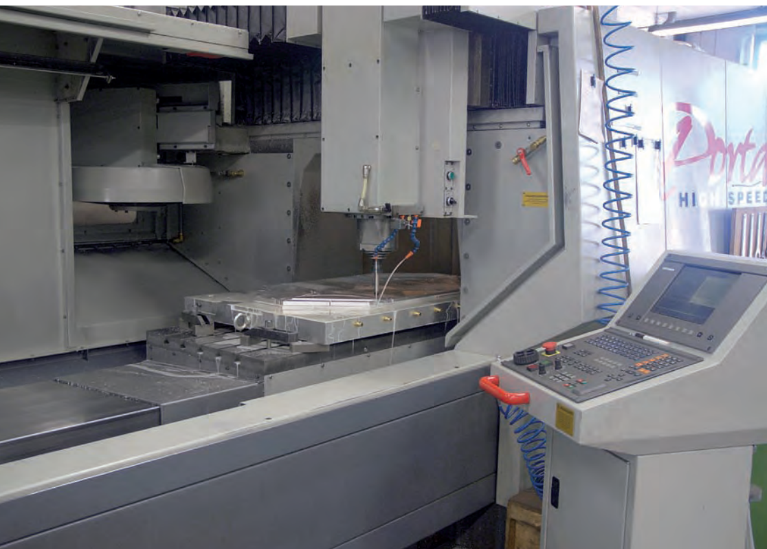
VMT Products beschikt over moderne bewerkingscentra voor de productie van matrijzen tot 2000 x 1500 mm.
