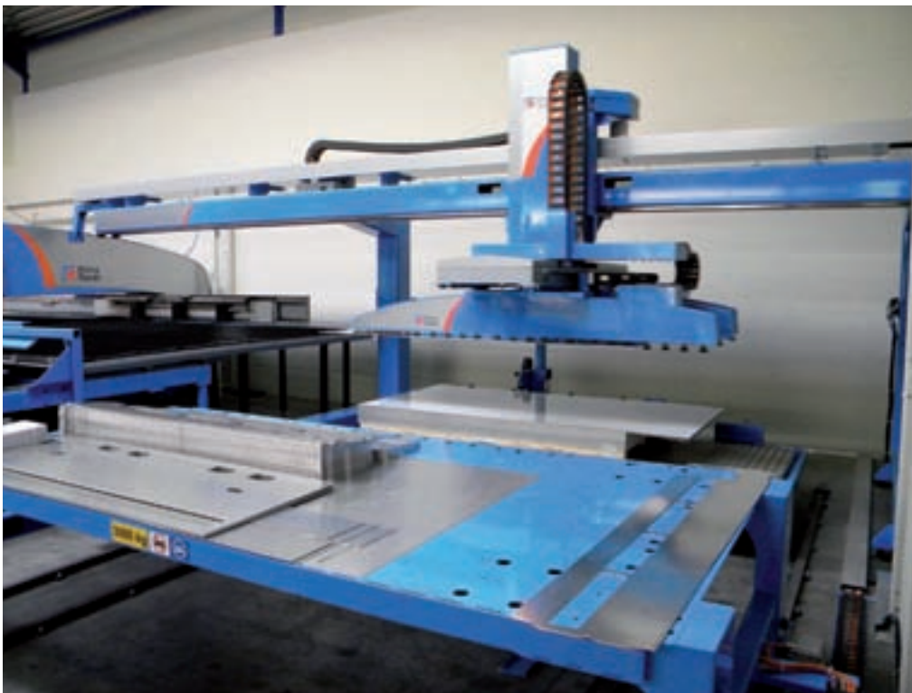
De productie en handling van plaatdelen verloopt heel efficiënt. Op de foto heeft een LST-robot zojuist een plaat opgenomen (een sensor beveiligd tegen onbedoeld opnemen van twee platen) en brengt deze over naar de machine.
