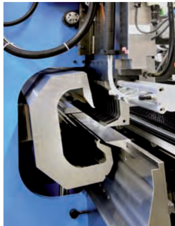
Een CNC-buigcentrum geeft in combinatie met een coil-ponscentrum een uiterst flexibele productielijn met een hoge output.
