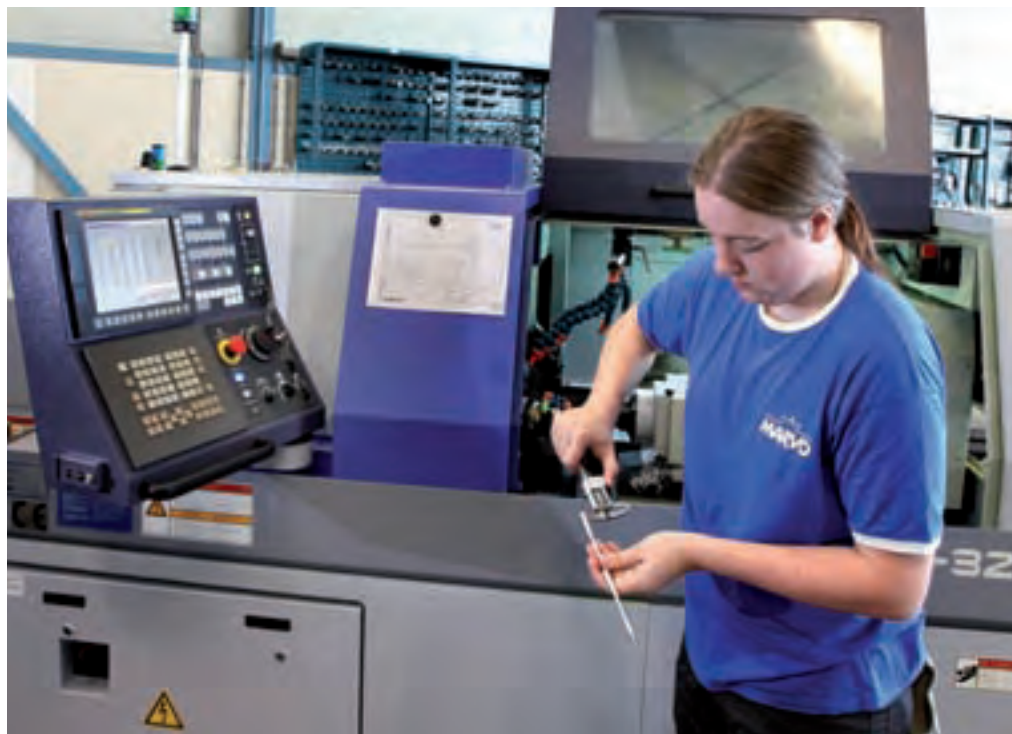
Eén van de zeventien medewerkers van Marvo Technologies controleert een langdraaicomponent.
