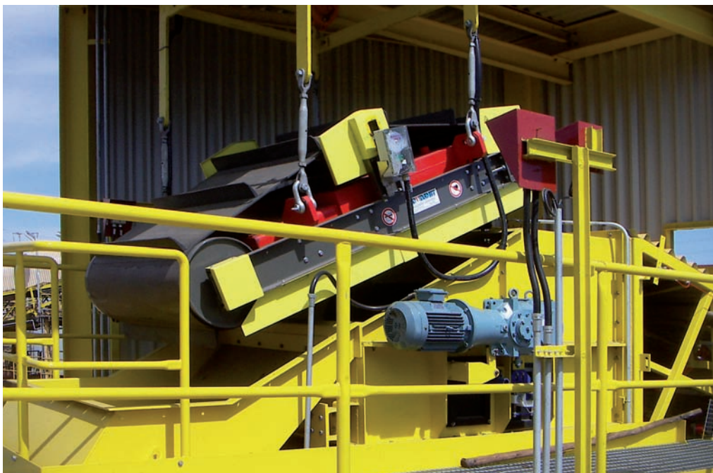
Bovenbandmagneet voor de recyclingindustrie, in dit geval houtverwerking.
