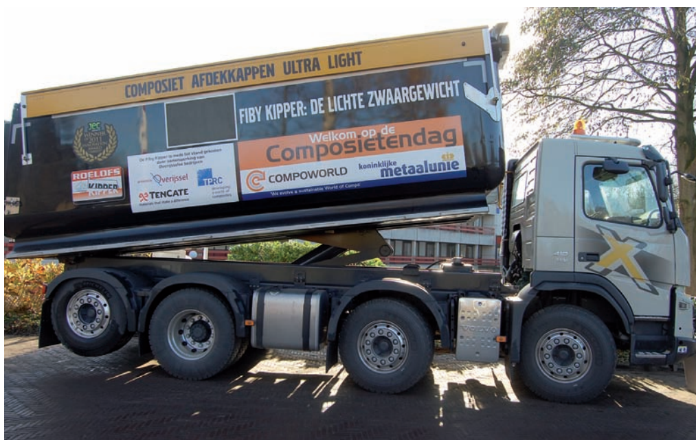
De FIBY kipper werd ontwikkeld door een consortium van Overijsselse bedrijven. De kipper is gemonteerd op een Volvo FMX 420 8x4 en is de helft lichter, sterker, energiezuiniger en stiller dan de huidige metalen kipper (foto: Tony van der Meer).
