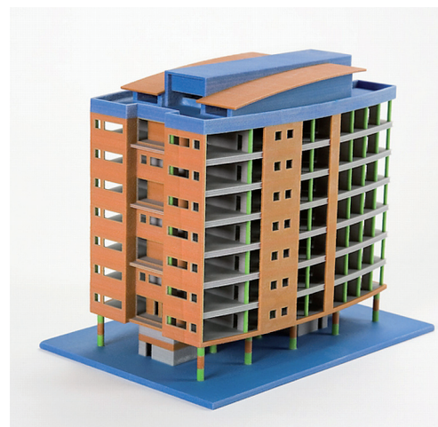
Model van een woning geprint met een 3D-printingmachine van ZCorp.
