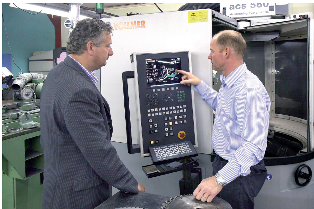
Ruud van de Laar (rechts) legt Frans van der Brugh de werking uit van een Vollmer CNC-slijpmachine, waarmee hardmetaalzagen volautomatisch geslepen kunnen worden.
