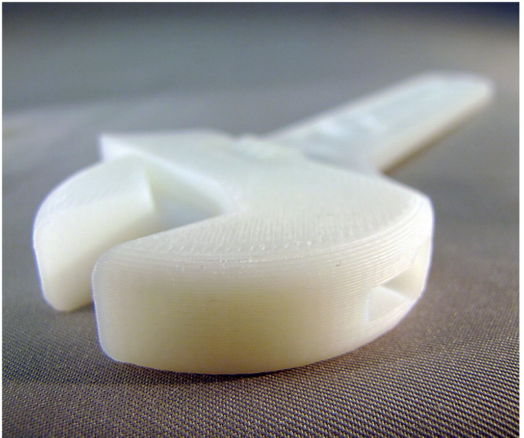
De geometrie van het basismateriaal (draad) is nog deels zichtbaar (FDM).
