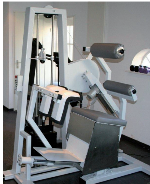
De eerste uitvoering van het Mobex-toestel. De gewichten zijn nog aanwezig, maar uitgeschakeld en vervangen door een motoraandrijving.
