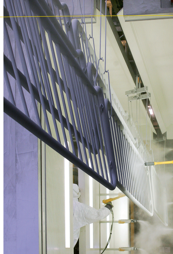
Totaalconcept van verzinken en poedercoaten: corrosiebescherming en een fraai uiterlijk in elke gewenste kleur, waaronder metallics en effectlakken.
