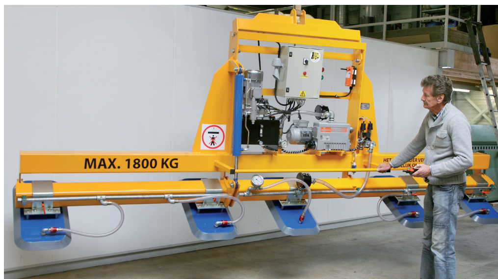
Nieuw type vacuümheffer waarvan de hoofdtraversebalk langer of korter te maken is door middel van een schuifstelsel en waarvan de uiteinden bovendien opklapbaar zijn.
