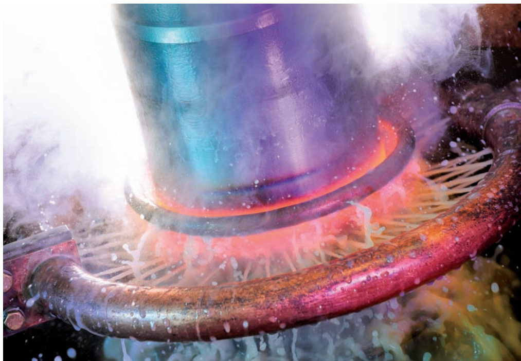
Inductieharden van een as, waarbij de spoel van beneden naar boven langs de as beweegt en volgens nauwkeurig ingestelde parameters warmte inbrengt. Door daarna te koelen ontstaat de oppervlaktehardheid.
