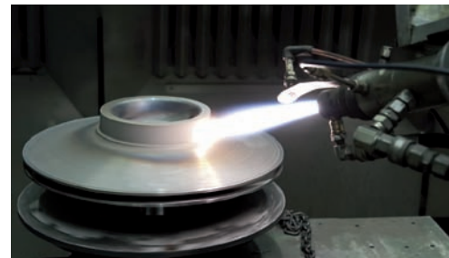
De HP-HVOF deklagen zijn meestal gebaseerd op wolfram- en/of chroomcarbide.
