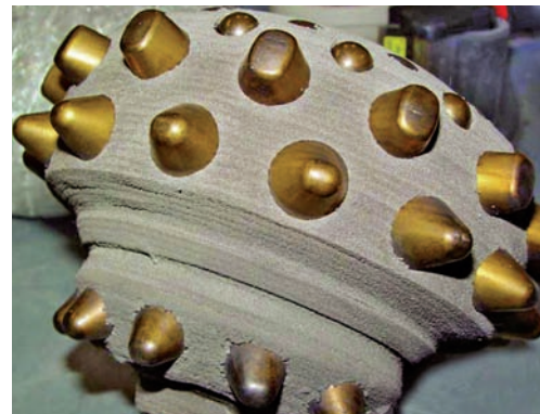
Rvs onderdeel uit de oliewinning wordt gelaserclad met een poeder van wolframcarbide.
