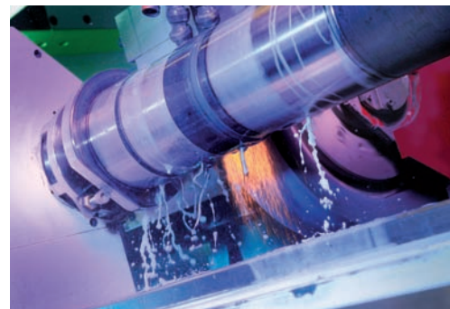
Nabewerken van een geharde as op een rondblijpmachine.
