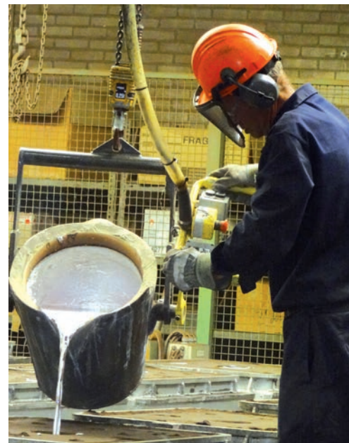
Vloeibaar aluminium wordt in een zandvormkast gegoten.
