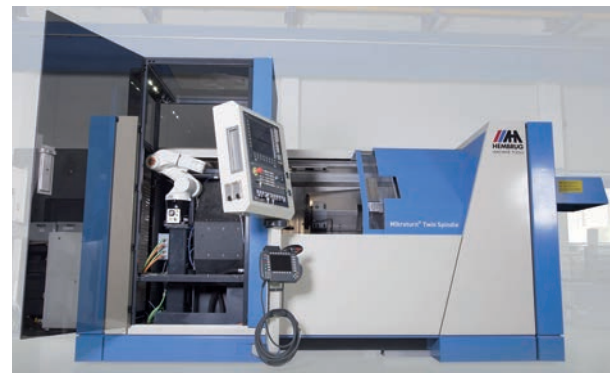
De Hembrug TwinSpindle met dubbele spil, robotbelading en geïntegreerde spilmotor is de nieuwste ontwikkeling op harddraaigebied. (Foto Heidi Borgart)
