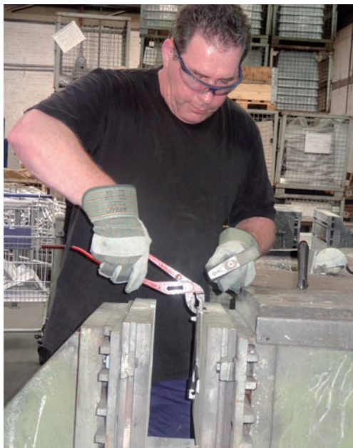
Coquillegieten: vloeibaar aluminium wordt handmatig in de vorm gegoten en na stolling verwijderd.
