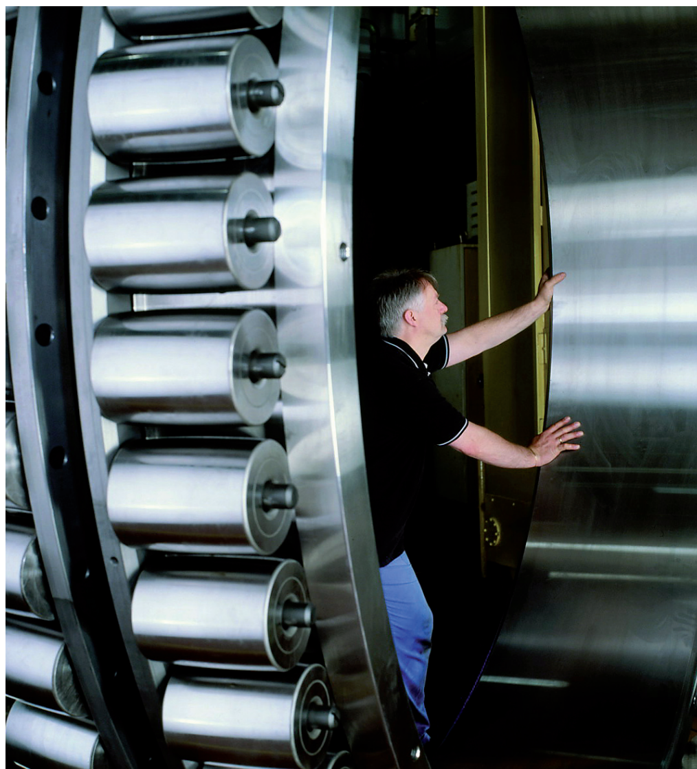
Bij de finish harddraaibewerking van de lagers, ingebouwd in de pendelrollagers van The London Eye, zijn Mikrotorn harddraaimachines van Hembrug ingezet. (Foto Schaeffler Group)
