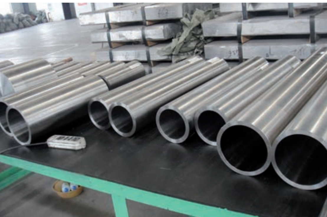
Dikwandige titaanbuizen, die als mantel dienen voor hydraulische cilinders van titaan grade 5. Ze zijn vervaardigd door Titan Projects in Sneek ten behoeve van de Noorse offshore.
