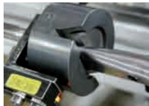
Conisch gereedschap om de uit het magazijn genomen buisdeelt, waarvan de uiteinden al zijn afgewerkt, exact te positioneren. Daardoor weet de robot precies hoe hij het deel in de machine moet leggen om het vervolgens nauwkeurig te kunnen buigen.
