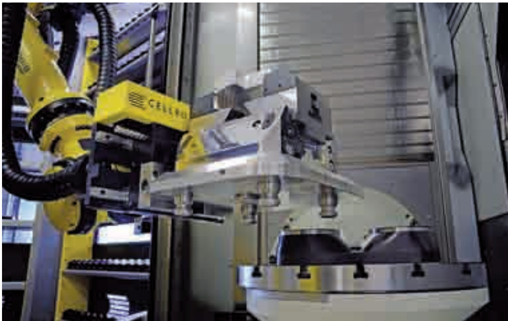
De universele gripper van de Cellro Smart Cell kan zowel pallets als producten manloos wisselen. (Foto: Cellro).
