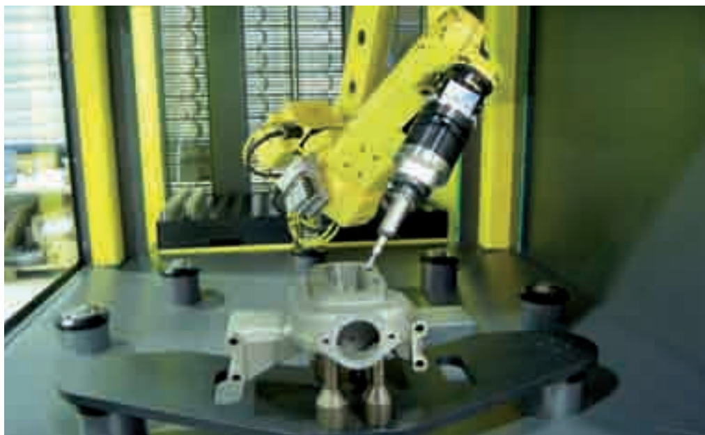
Complex, stationair opgesteld werkstuk wordt door de robot met diverse gereedschappen ontbraamd; de kleine robot is zo flexibel dat hij ook gemakkelijk op lastig toegankelijke plaatsen komt.
