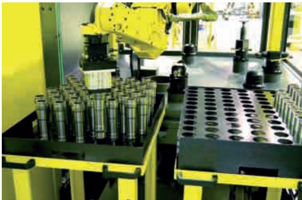
Robot pakt vanuit een multifunctionele transportkar de te ontbramen producten.
