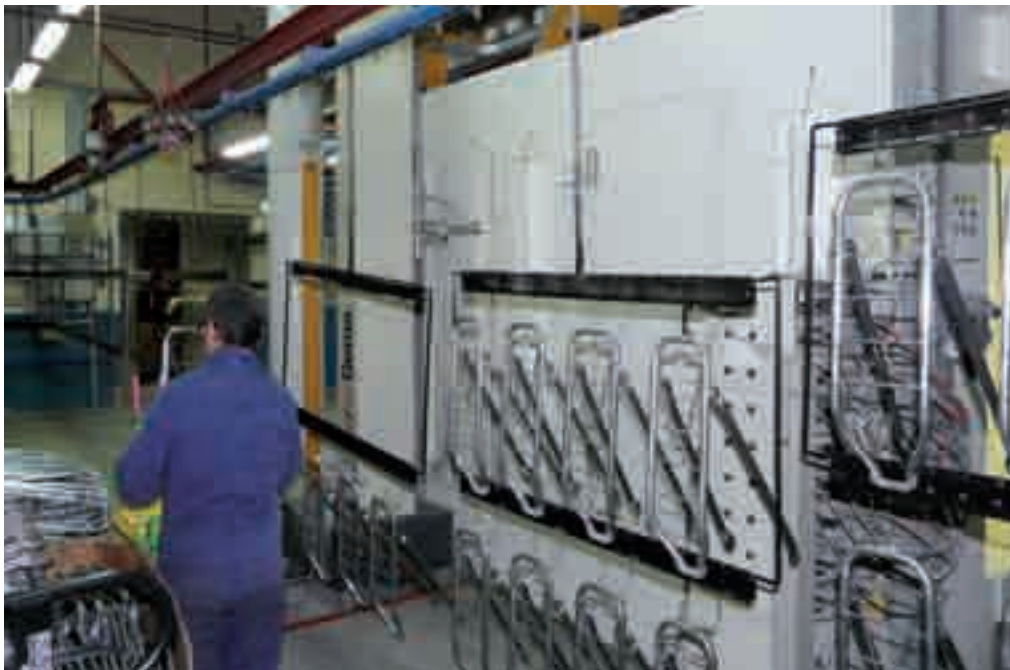
Bagagedragers worden op de lijn gehangen om vervolgens in de geautomatiseerde lakstraat te worden voorzien van een duurzame poedercoating.
