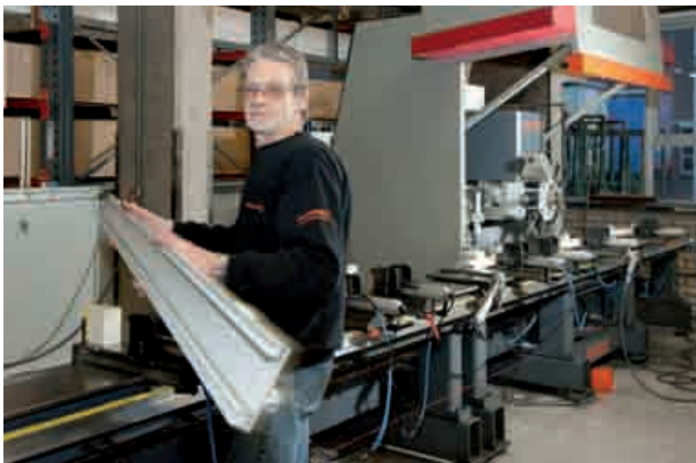
De metalen frames worden door Interwand geproduceerd. Op de werkplaats in Eibergen staat een uitgebreid machinepark om te zetten, zagen, boren, frezen en felsen.
