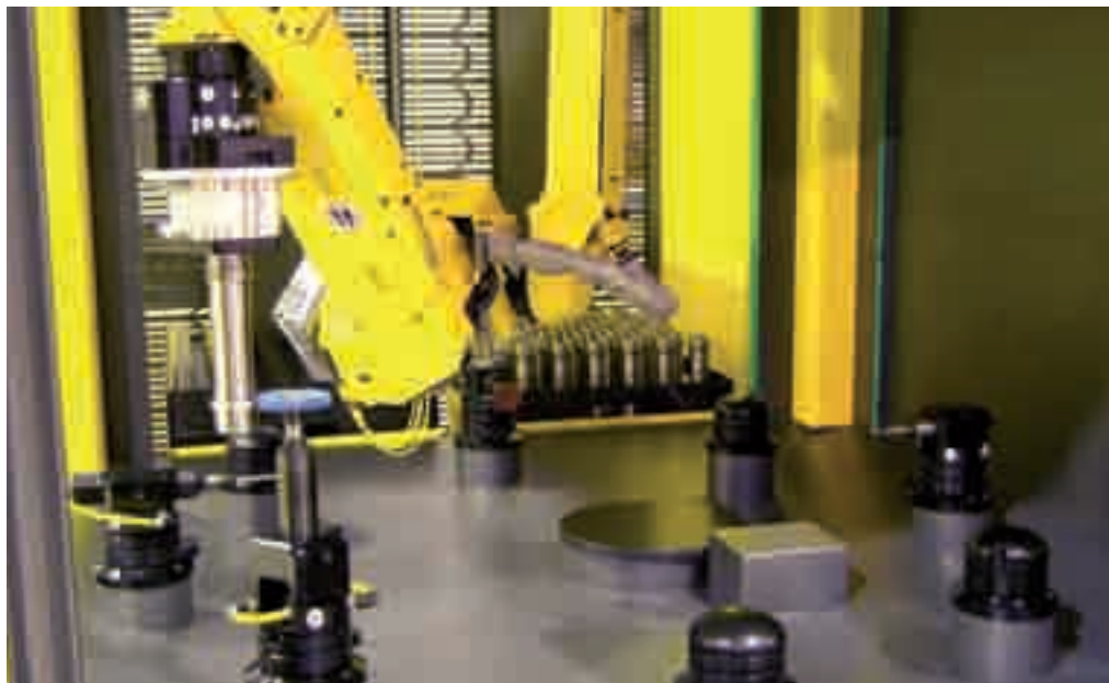
Ontbraamcel waarbij het werkstuk door de robot langs de verschillende ontbraamstations wordt gevoerd.
