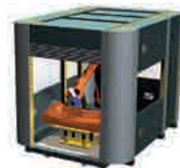
Cellro robotcel voor (frees)-bewerking van modellen. Verspanen van kunststoffen met een robot is goed mogelijk, bij metalen wordt het een probleem. Ontbramen kan echter goed worden uitgevoerd.
