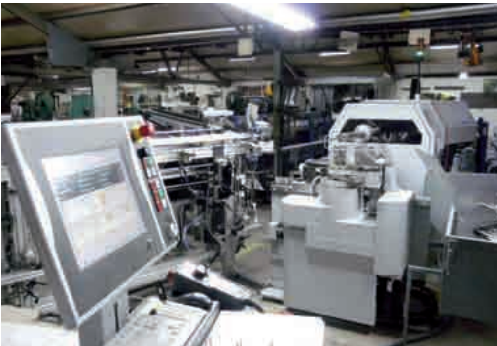
De nieuwe Wafios BMZ61 buigautomaat. Links de besturing, in het midden het buizenmagazijn en rechts de machine. Een robotarm die ook de buigcyclus stuurt, haalt de buizen uit het magazijn en plaatst/positioneert ze op de machine.
