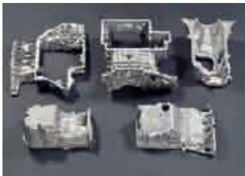
Aan complex gevormde werkstukken valt heel wat af te bramen.
