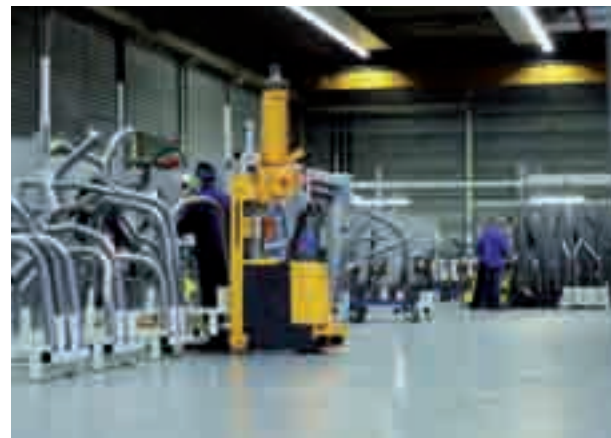
Mass Customization bij trapliftfabrikant Thyssen Krupp Encasa: de programma's voor de lasrobots worden automatisch vanuit de CAD en ERP data gegenereerd. (Foto: Erik Steenkist).
