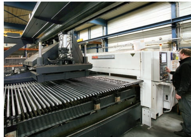
De Mazak STX 510 MKIII CELL is een 2500 W zware machine met een plaatafmeting van 3000/1500 mm.
