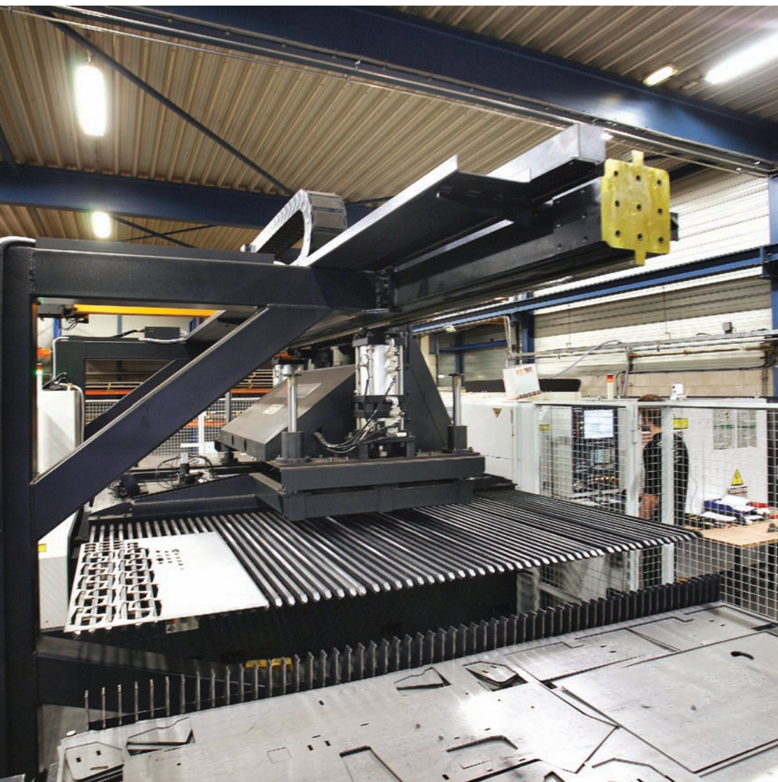
Van Pelt koos voor de Mazak STX 510 MKIII CELL in de eerste plaats vanwege de mogelijkheid de machine 24/7 onbemand te laten draaien.
