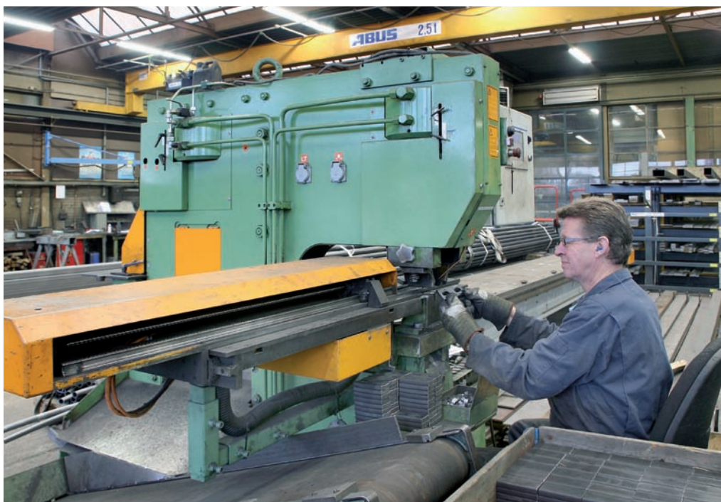
Met de bewerkingsmachine worden gaten gestanst in stalen profielen.
