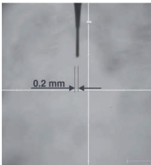
Een optisch systeem kan tot op enkele micrometers nauwkeurig meten, zelfs freesjes van 0,2 mm.
