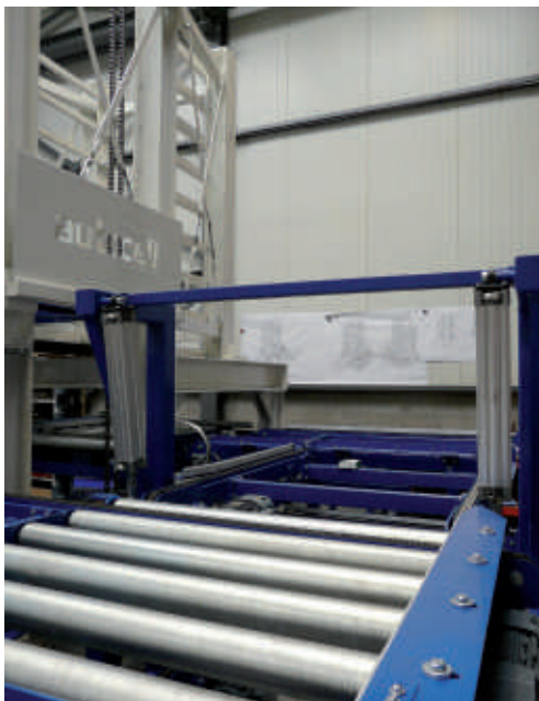
Door middel van pneumatische cilinders worden de rollenbanen gepositioneerd.
