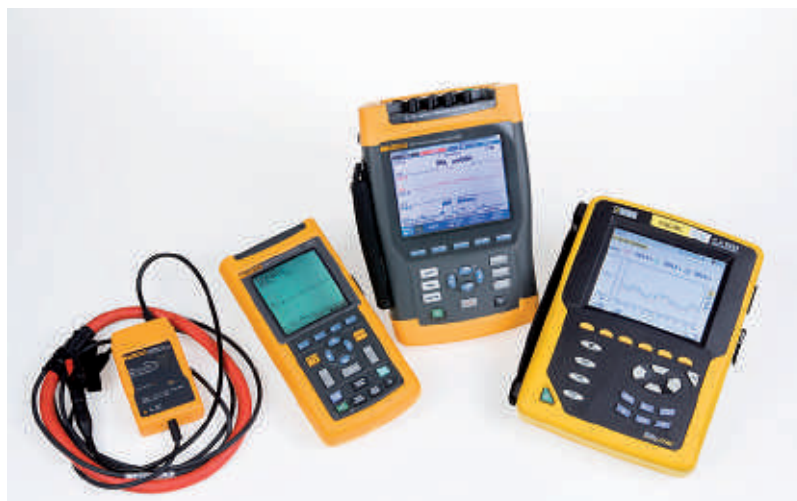
Meet- en analyse-apparatuur die Escail Engineering toepast met v.l.n.r.: Fluke i3000 Flexstroomtang 3000 Amp, Fluke 123 Industrial Oscilloscoop, Fluke 435 Power Quality Analyzer 3000 Amp, Chauvin Arnoux Power Quality Analyzer 3000 Amp.
