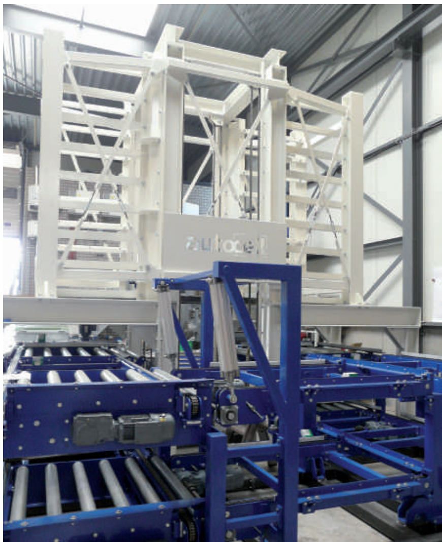
Detail van een AutoCell productiecel, met op de voorgrond de aan- en afvoersystemen voor de pallets en op de achtergrond het magazijn.
