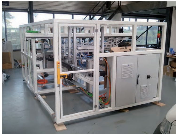
De automatisering staat klaar voor verzending naar Amerika. Zichtbaar zijn het toegangshek naar de matrijs en de besturingskast met de servodrive's.
