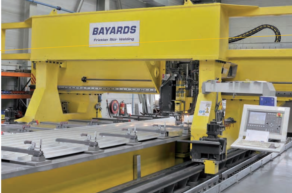
Eén van de grootste FSW-lijnen van Europa, onder meer toegepast in de productie van romp- en deksegmenten voor de jachtbouw.
