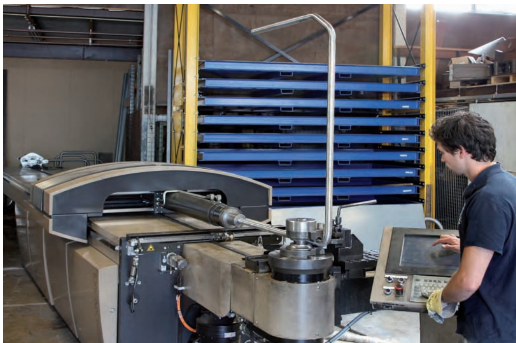
Medewerker Maurice Kooijmans bij de Dynabend combi 76, een buig- en walsmachine. In de machine is een onderdeel voor een fitnessstoel te zien.
