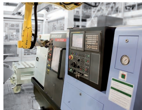
In de Fastems Robot Production Cel hangt de robot in een gantry-concept boven de draaimachine.
