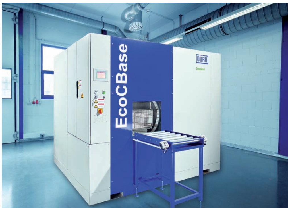
Bij de verwijdering van polaire vervuilingen zoals zouten, emulsies, polijstpasta's en slijpsel zorgen watergebaseerde systemen voor economische processen. De EcoCBase W3 dekt een breed reinigingspectrum af.
