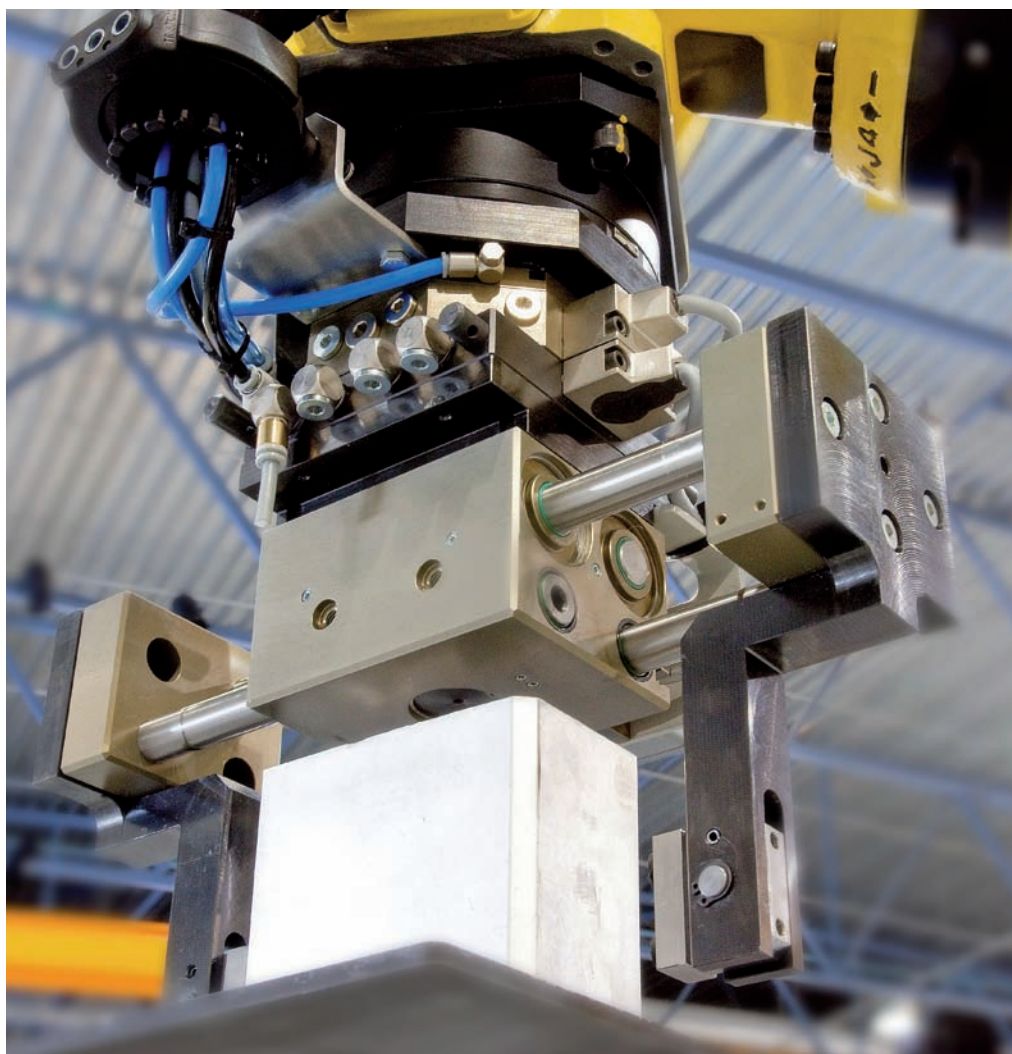
De Fanuc robot en de universele gripper kunnen werkstukken tot 20 kg handelen.
