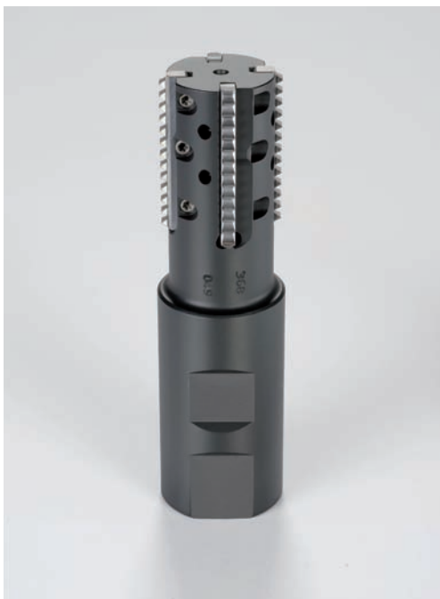
Speciale draadsnijfrees waarmee in één keer meerdere gangen schroefdraad gefreesd worden zodat hoge productiesnelheden te realiseren zijn.
