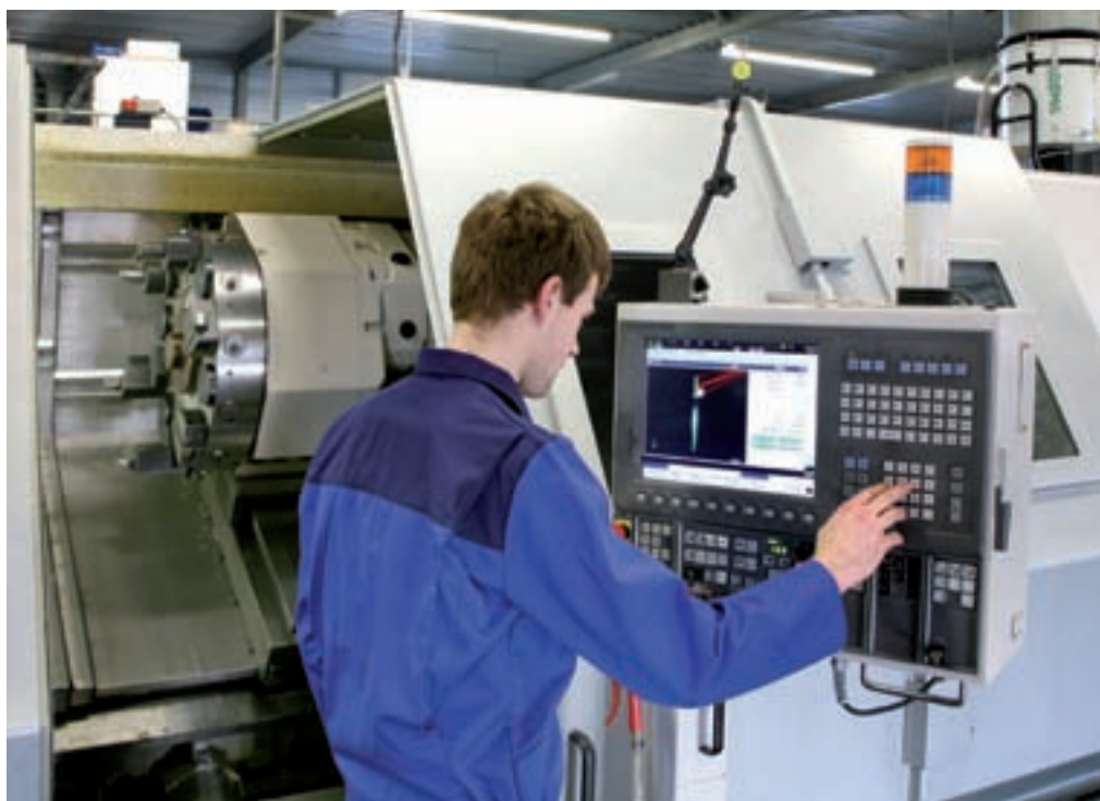
De revolver met twaalf posities maakt het mogelijk freesbewerkingen op de draaimachine uit te voeren.
