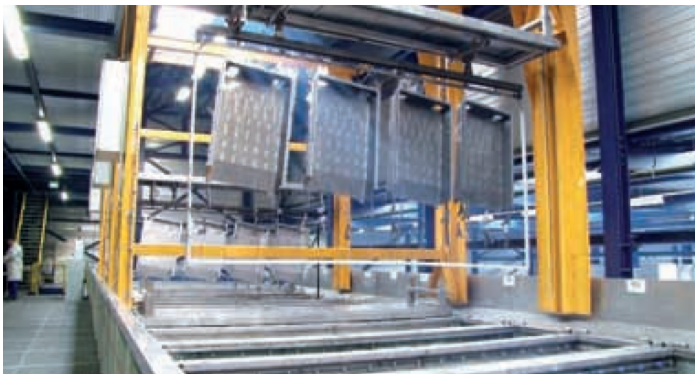
In de KTL-lijn kunnen delen met afmetingen tot 5 x 2,5 x 0,07 m. en een gewicht tot 1.000 kg worden behandeld.
