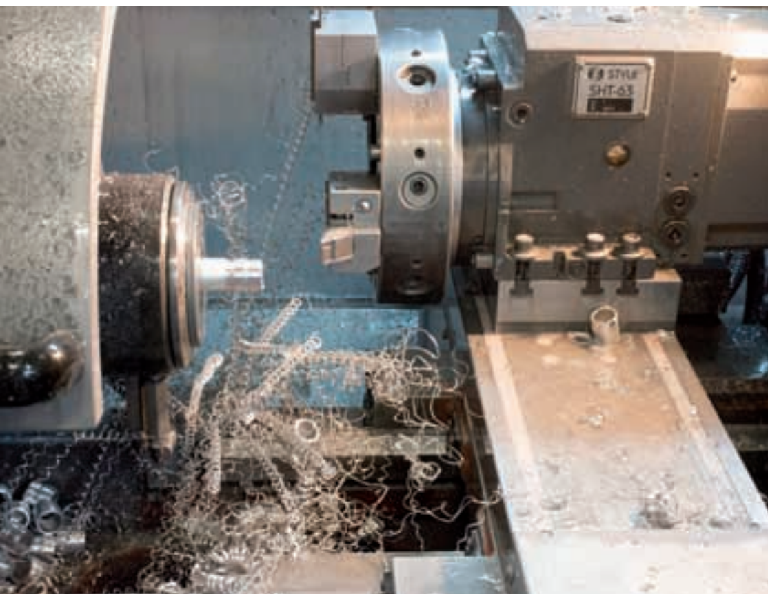
Een volautomatische freesmachine produceert conische pluggen, die linksonder te zien zijn.
