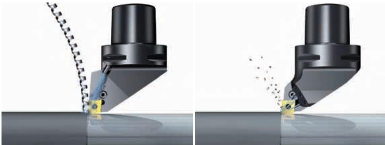
Door te koelen onder hoge druk, direct gericht op het snijvlak, breken de spanen sneller af (illustraties: Sandvik Coromant).
