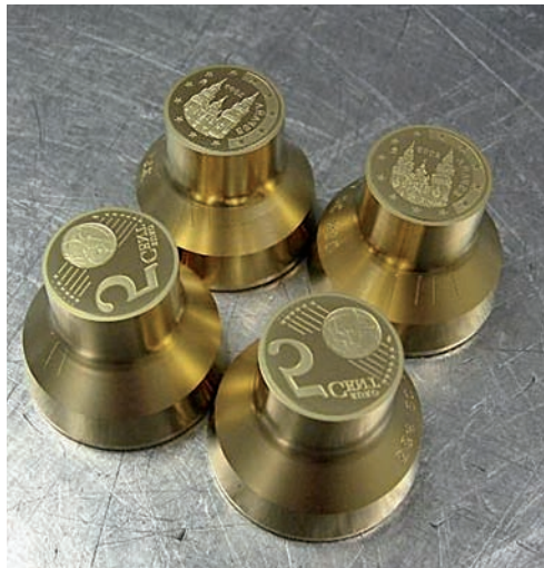
Stempel voor Spaanse vijfcentsmunten, gecoat met Balinit A (TiN). Een alternatief is Alcrona (AlCrN), dat de standtijd opvoert van 7.000 tot ruim 150.000 slagen.
