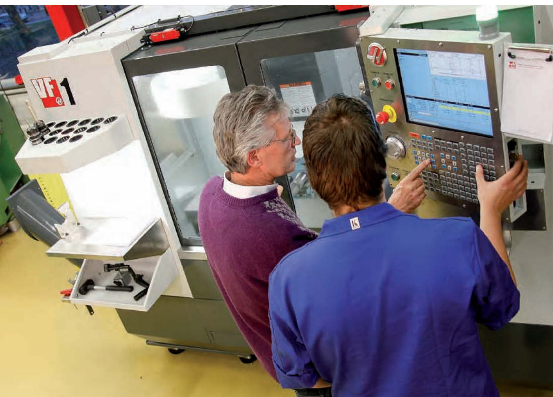
Studenten op mbo-niveau 4 leren de principes van CNC 3-assig frezen op een Haas VF-1 bewerkingscentrum.
