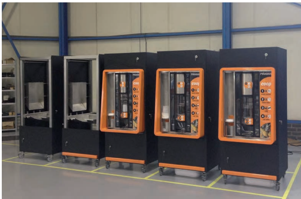
BM Boxmeer ontwikkelde samen met ingenieursbureau TCPM de Piñabar: binnen twintig seconden komt een ananas geschild uit het apparaat, in een afsluitbaar emmertje.
