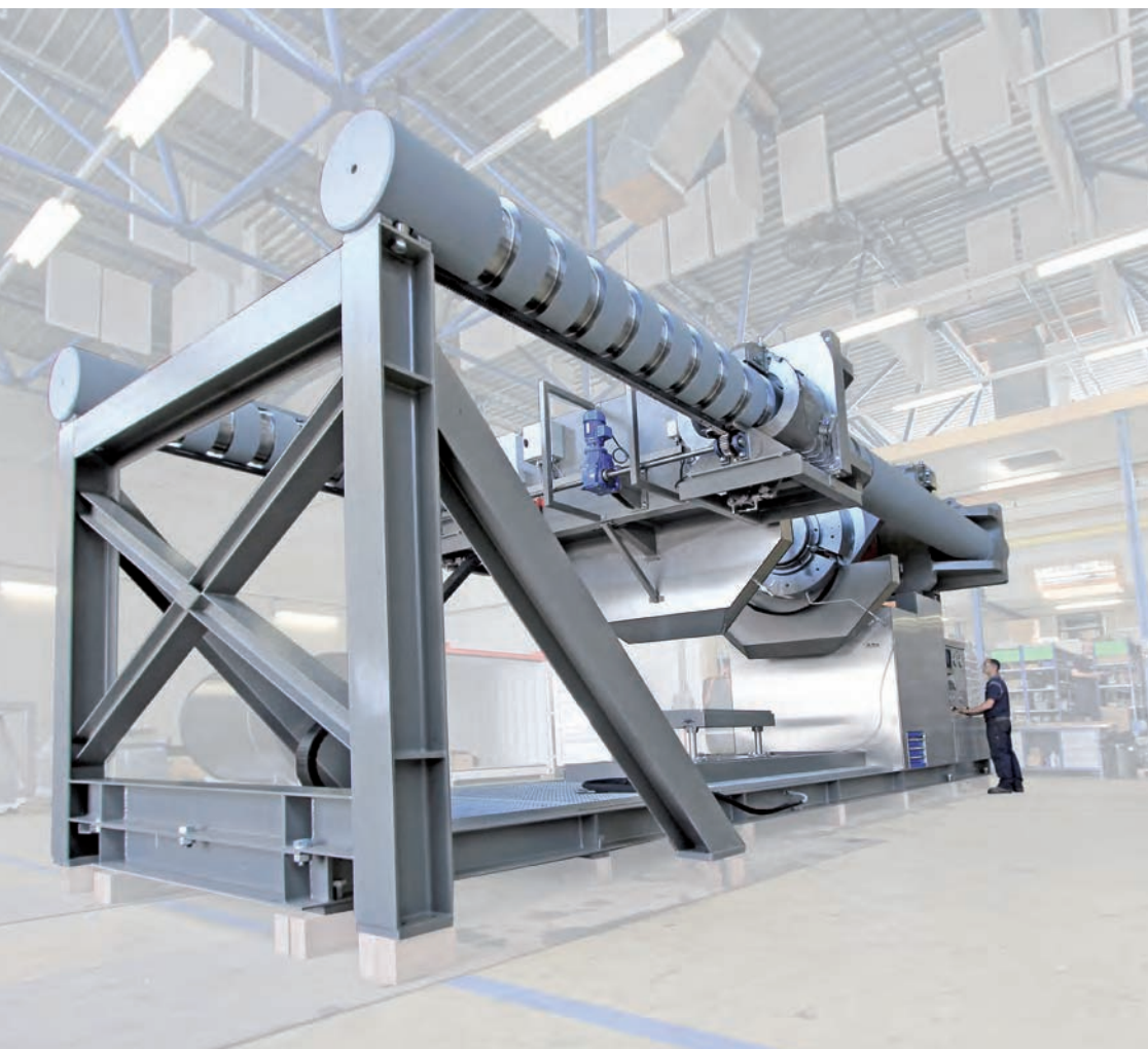
Deze indrukwekkende testmachine is geschikt voor afsluiters met een inwendige diameter tot drie meter.
