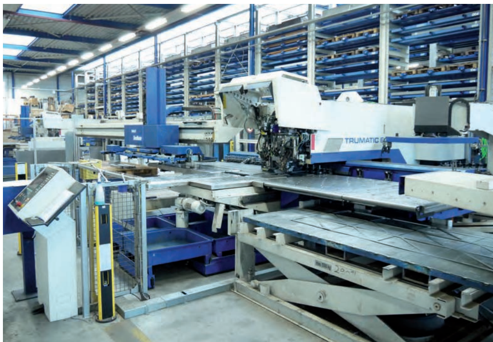
Pons-/lasermachine met daarachter een robotmagazijn met de voorraad plaatmateriaal.
