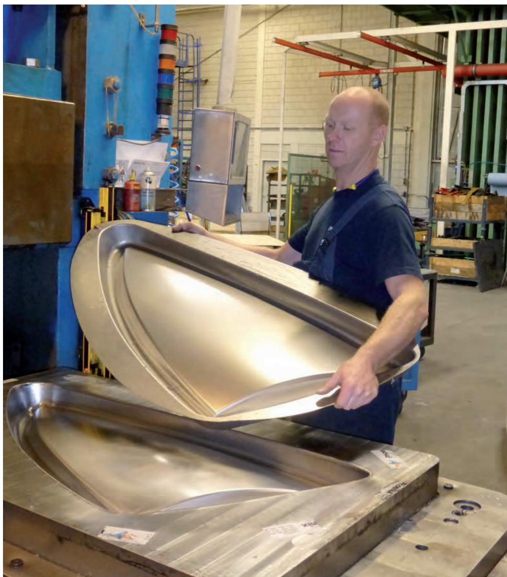
Dit 3D-gevormd productdeel voor een industriële verbrandingsinstallatie is samen met de klant ontwikkeld: lichtgewicht en goed schoon te maken.
