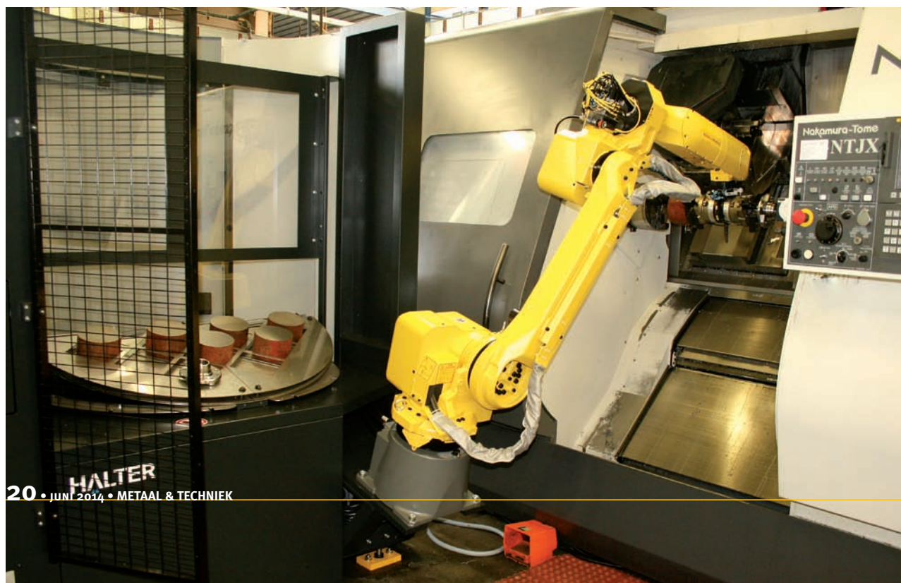
Een Nakamura NTJX Multitasking machine, met een productnauw- keurigheid van 20 mu.
