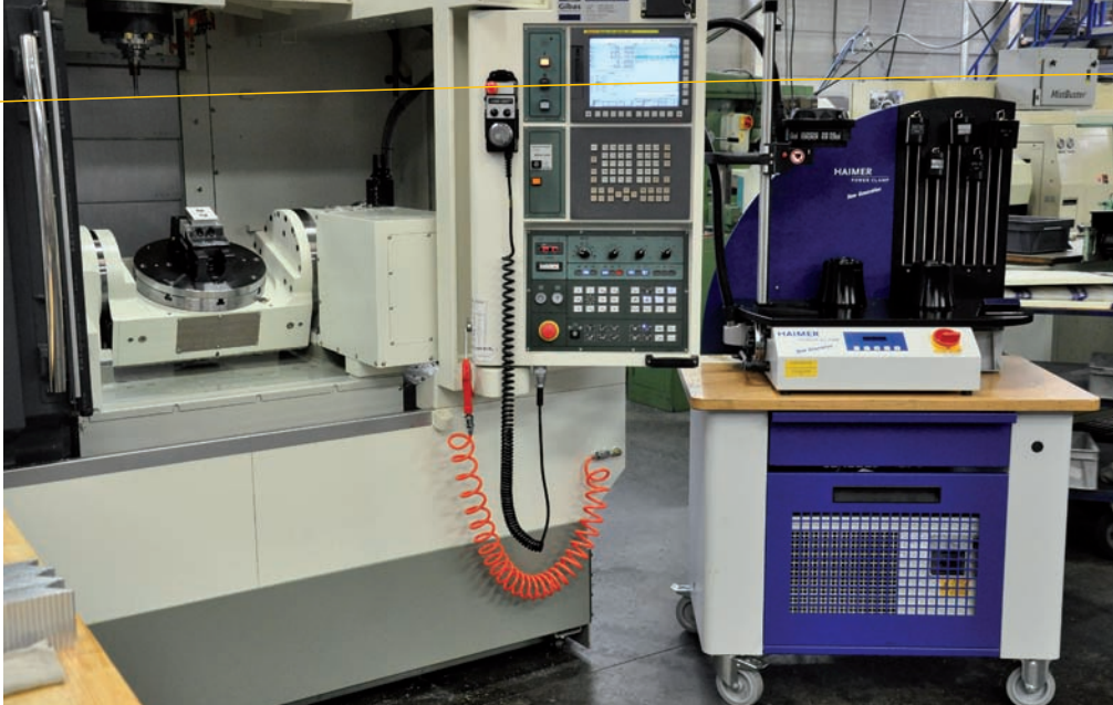
Krimapparatuur van Haimer voor een perfecte rondlooptrouwkeurigheid.
