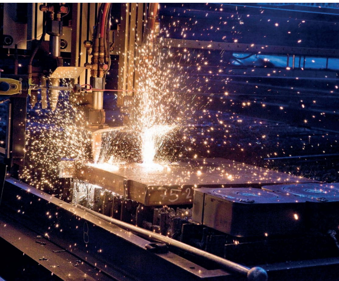
Platen tot 300 mm dik kunnen zeer nauwkeurig worden gesneden, van gaten en sleuven worden voorzien en zo nodig worden nabewerkt.
