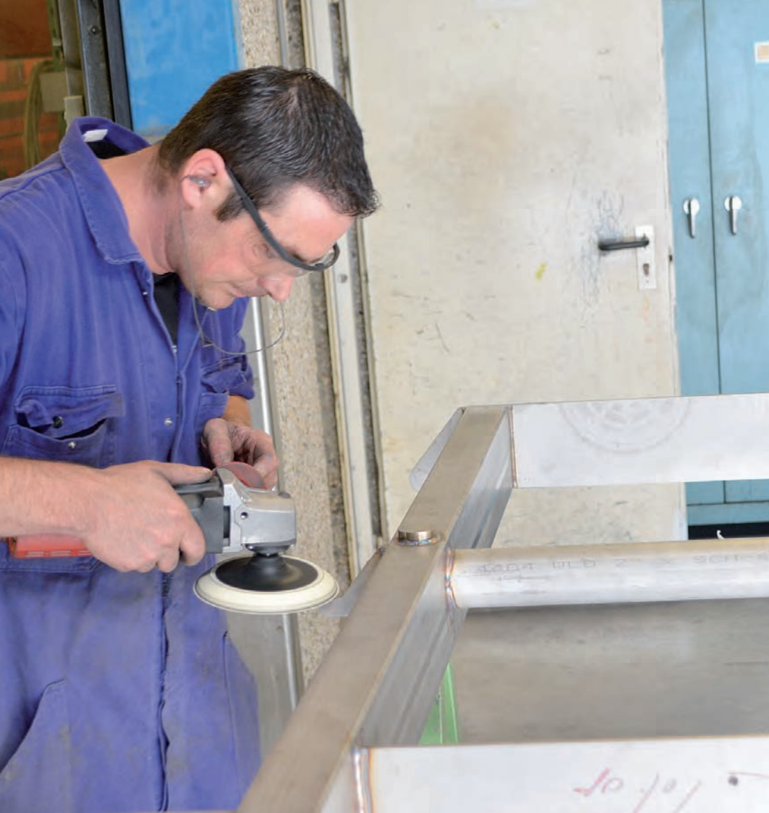
Een goede afwerking door schuren en polijsten van roestvaststaal is heel belangrijk voor de food- en medische industrie.
