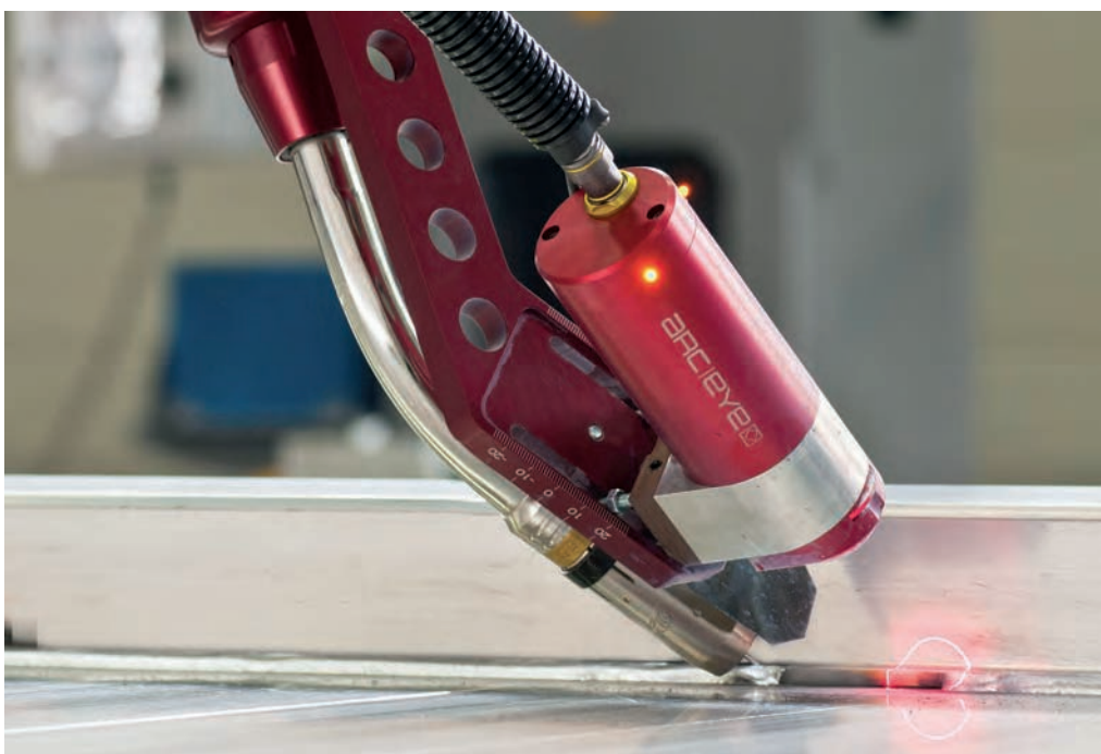
Toepassing van de Arc-Eye lasersensor bij het robotlassen van aluminium elementen.
